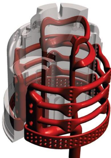
Élément de moule réalisé en fusion
